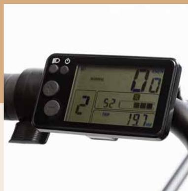
Il **display** permette di gestire l'assistenza elettrica e l'accensione delle luci con facilità.
