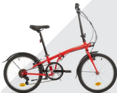
Telaio in acciaio Hi-Ten (peso: 14,5 kg). Provvista di cambio 6 velocità, molto semplice grazie all'impugnatura girevole. Corona 52 denti, ruota libera Shimano 6 velocità TZ20 14/28. Sviluppi in metri per un giro di pedali:
